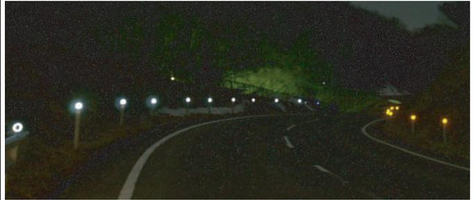
複数の製品が標準電波(J J Y)を元に、ぴったり同じタイミングで点滅します。同時点滅により光が連続するように見え、道路線形が把握しやすくなったり、人の視線を特定の方向へ自然と誘導することが可能になります。
