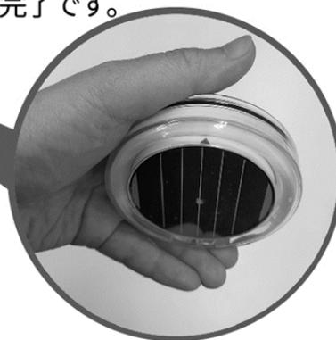
納入時は、電気二重層コンデンサは放電しています。発光点滅を確認するためには、晴天時に屋外で3時間以上、直射日光による充電を行ってください。
